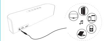
手机,电脑或者电视均有AUX 音频输出接口,请把随机附赠的3.5mm音频线两端分别插入音频输出
